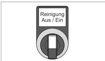
Abb. 54 Wahlschalter [Reinigung Aus/Ein]
