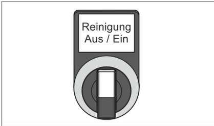
Abb. 55 Wahlschalter [Reinigung Aus/Ein]
