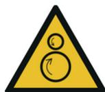
Arbeiten an den Einzugsstellen (z. B. drehende Bauteile) nur im Stillstand durchführen.
