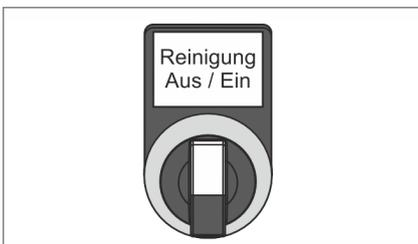
Abb. 56 Wahlschalter [Reinigung Aus/Ein]
